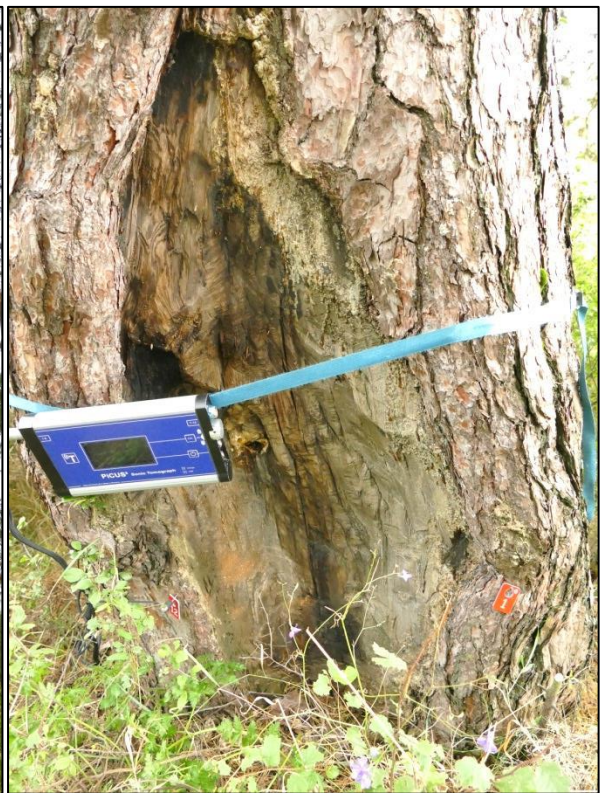
Zdj. 12. Badanie tomografem akustycznym
